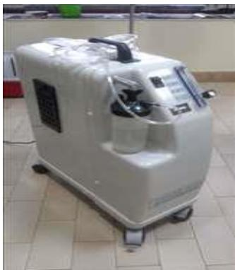
U osnovi su sačinjeni od molekularnog sita za koje se upotrebljava sintetski aluminijum silikat (Zeolit), koji apsorbuje azot i vodenu paru iz sobnog vazduha i tako produkuje kiseonik u koncentraciji iznad 90%.
